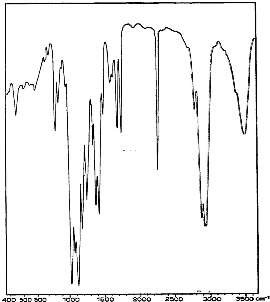
Fig. 1. Infrarotspektrum von Polyvinylformalpropionitril.
